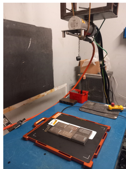
DR - Tir gamma avec embout d'irradiation ; Flat panel
