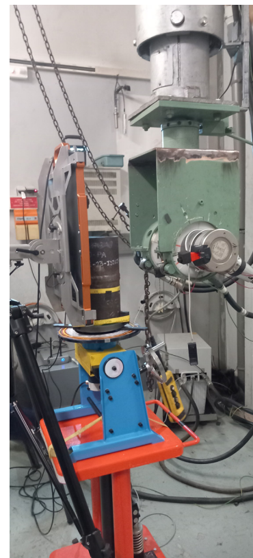
DR - exemple de radiographie numérique effectuée sur des coupons à l'aide du support, du plateau rotatif et d'un poste X (QS-QMOS)
